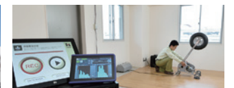
音体感室での遮音実験状況
