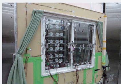
防露・断熱性能試験状況
