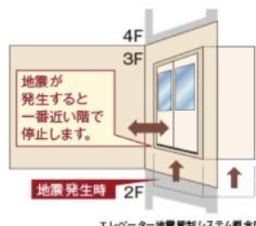
エレベーター地震管制システム概図
