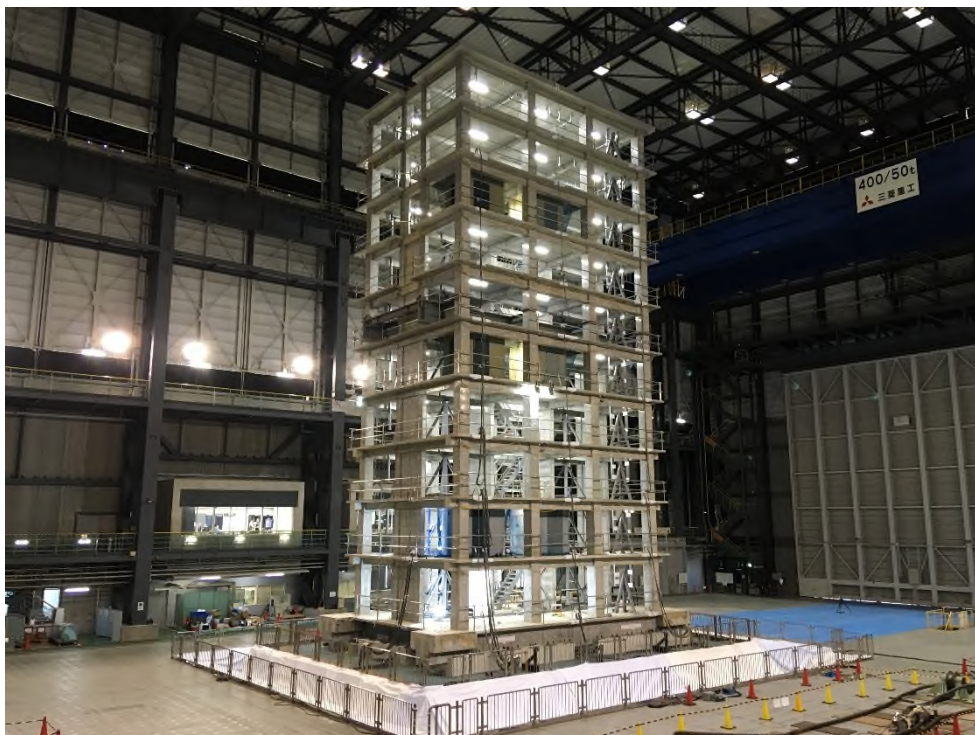
〔世界最大規模の実大試験体の全景（高さ約27.5m）〕
