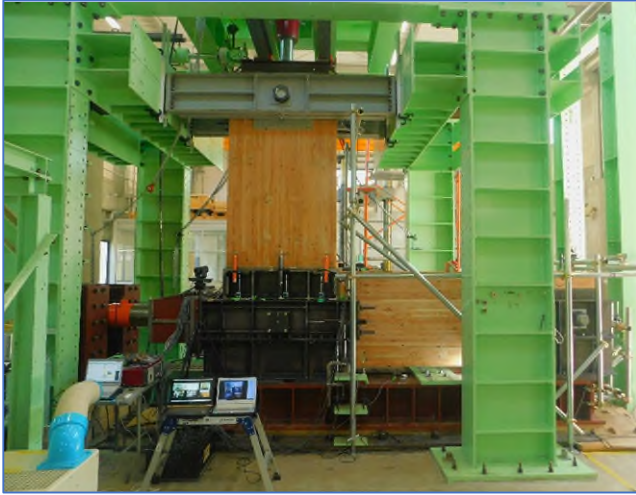
【実大実験の様子（左：GIUA、右：シアリングコッター耐力壁）】
