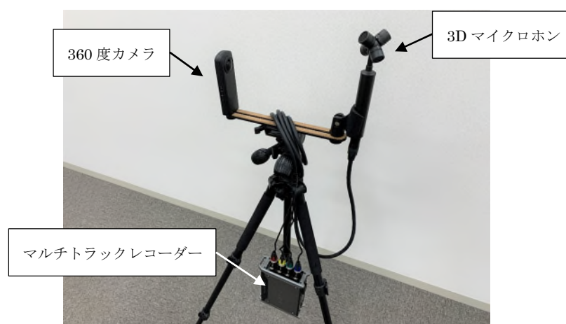
市販製品による計測システムの例（3D マイクロホン、360 度カメラ、マルチトラックレコーダー）
