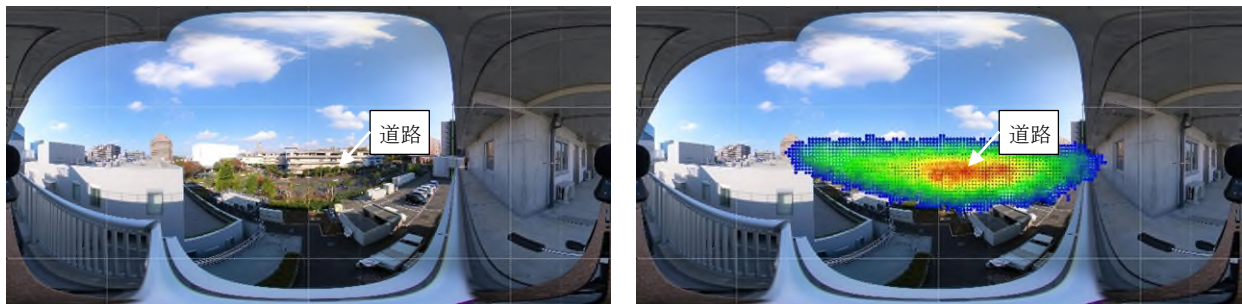
左図：カメラで撮影した 360 度画像、右図：360 度画像に音源方向の解析結果（道路騒音）を重ね合わせた図
