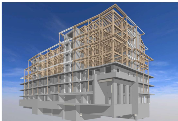
木造・RC造のハイブリッド構造 モデル図
