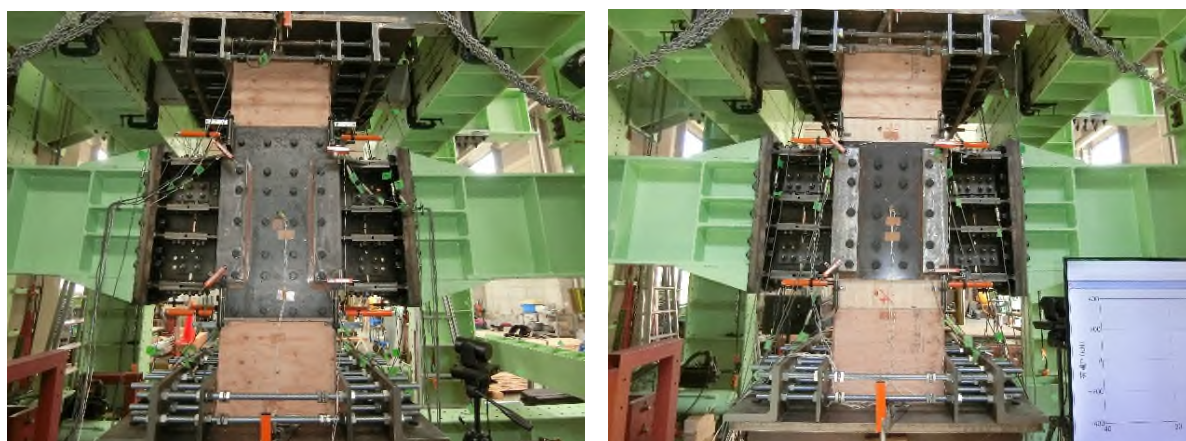
【実大実験の様子(左:柱の仕口プレートの高さを拡張させたタイプ、右:標準タイプ)】
