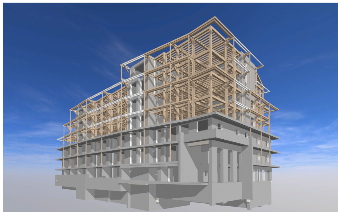
木造+RC造 ハイブリッド木造 モデル図
