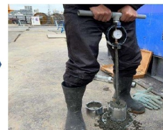
品質検査（コーン貫入試験）
