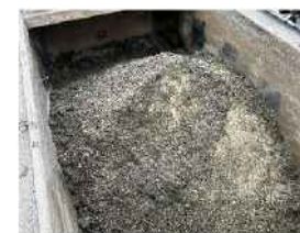
福岡大学と共同開発した建設汚泥固化処理技術で明日香村の竹をチップにして活用 (CO2排出量約50%削減)
