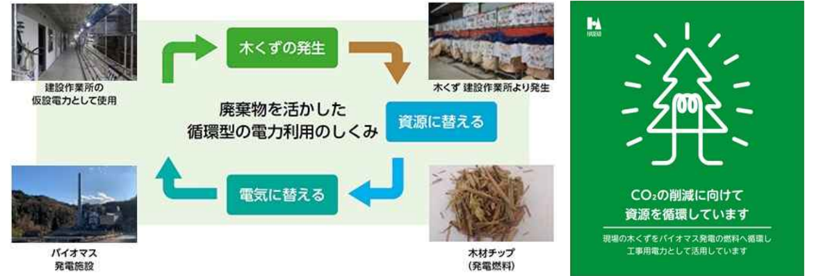
建設作業所で発生した木くずを活用したバイオマス発電の導入
