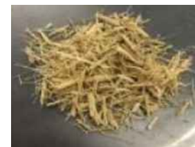
福岡大学と共同開発した建設汚泥固化処理技術で明日香村の竹をチップにして活用 (CO2排出量約50%削減)
