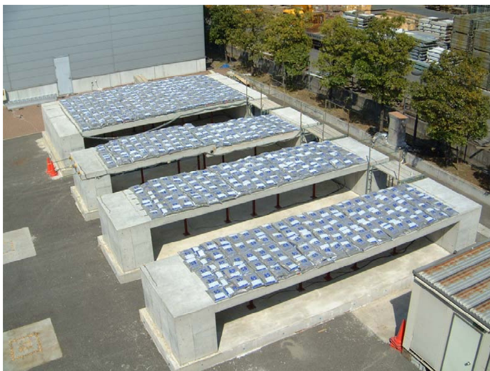
【大型実大試験体を用いた長期載荷実験風景（技術研究所内）】
