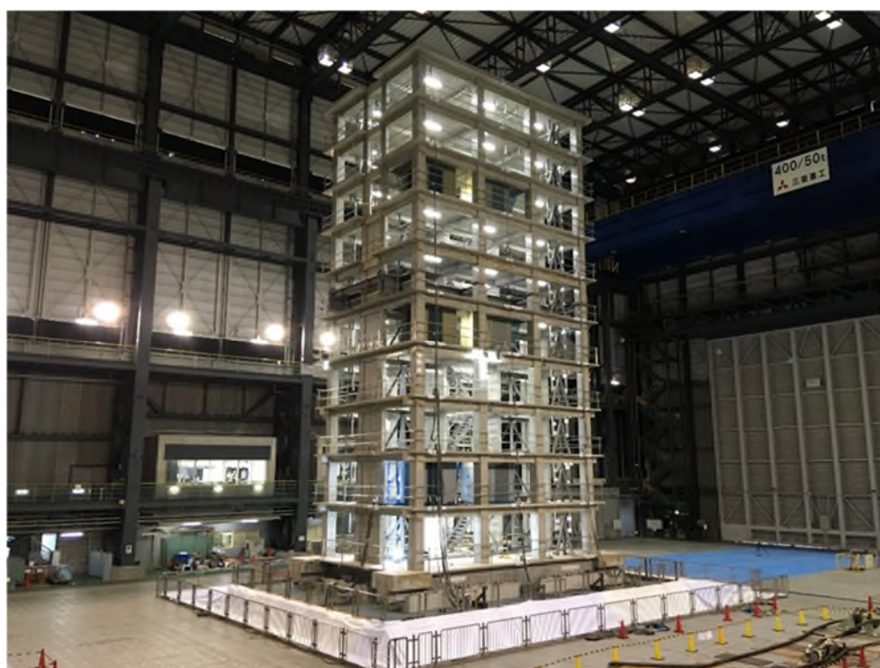
〔世界最大規模の実大試験体の全景（高さ約27.5m）〕
