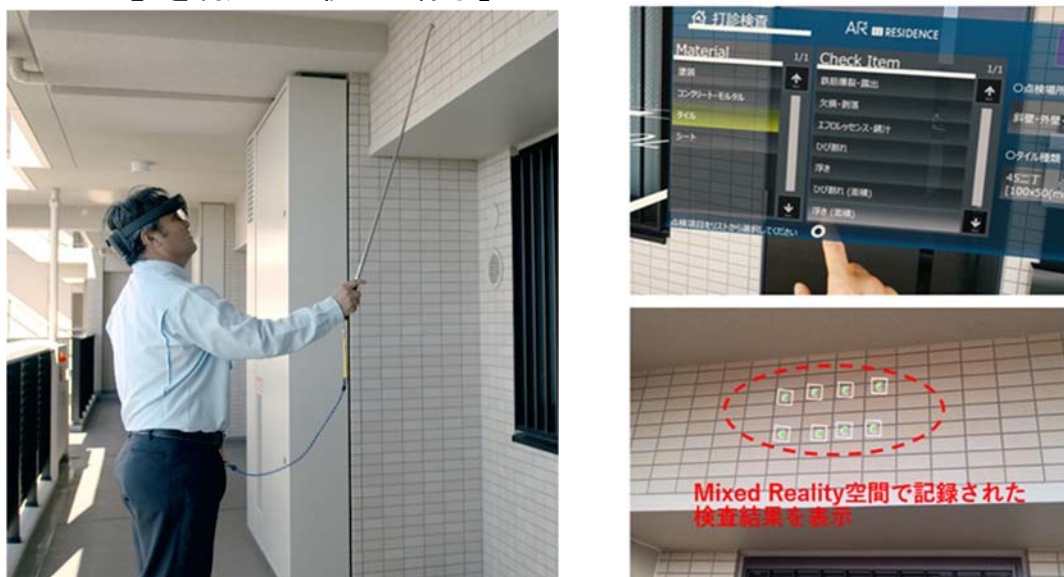
【左：HoloLens 2 を付けた打診検査の様子、右上：検査記録項目選択画面、右下：タイル浮き入力例】
