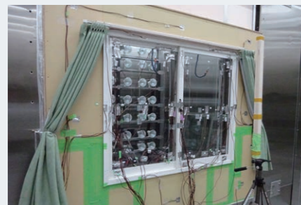
防露・断熱性能試験状況
