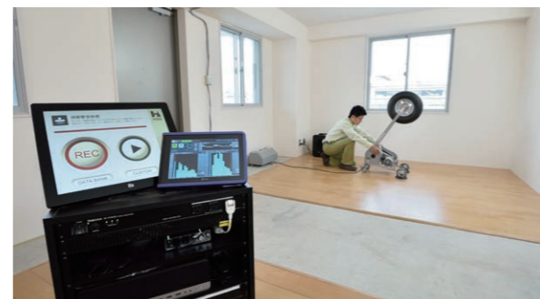
音体感室での遮音実験状況
