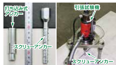
スクリュアンカーの引張り強度試験
