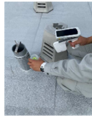
試験ボール投入の様子
