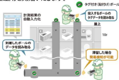
RFIDを用いた排水管通球試験の流れ
