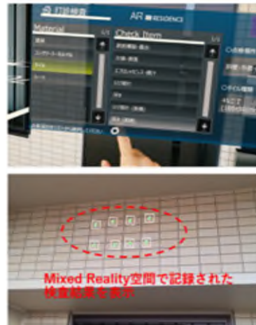
上：検査記録項目選択画面 下：タイル浮き入力例
