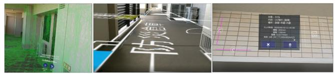
[左:3D モデルを作成する際のイメージ 中:平面図を現場へ重ね合わせ 右:MR空間に調査結果を記録]
